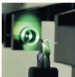
berührungslose Vermessung der Werkzeugschneiden
