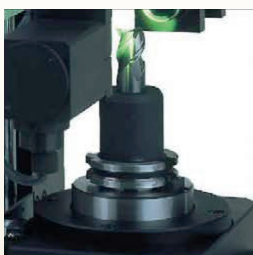
präzisionsgelagerte Aufnahmespindel 90° Indexierung (optional)
