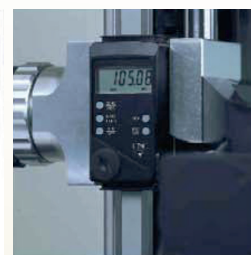
bewährtes Messsystem von Mitutoyo mit Datenausgang in beiden Achsen
