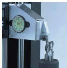
Präzises Messen durch 2D-Taster 90° Indexierung an der Aufnahme- spindel (optional)
